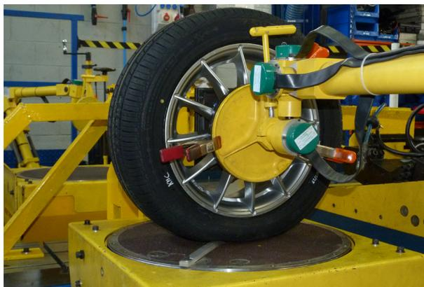
• **IDIADA 室内タイヤ実験室**：各法規で規定された条件での転がり抵抗の試験などが実施可能です。
