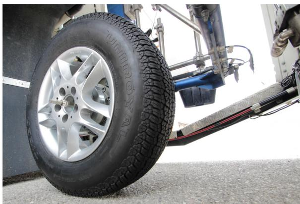
• **IDIADA K&C 試験機 (キネマティック&コンプライアンス試験装置)**：タイヤの静的な剛性測定に使用しています。タイヤと路面の相対位置、姿勢角を制御しながら入力を与え、各方向の動きと力を計測します。装置のプラットフォーム上のタイヤ接地面に5分力（上下、左右、前後、ステア、およびロール方向）を負荷します。
